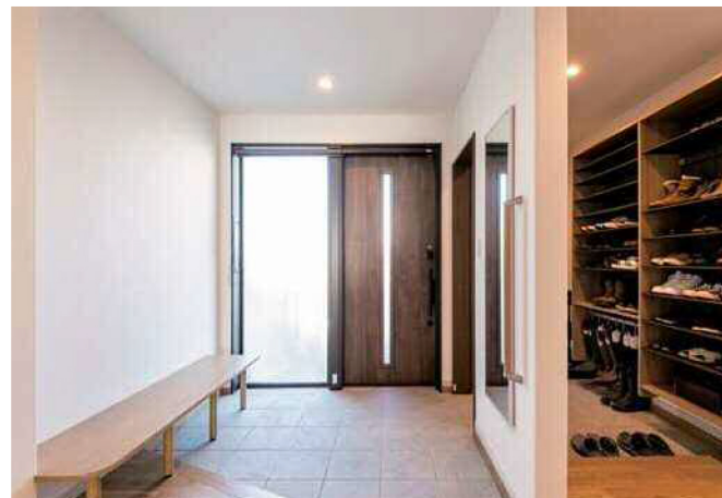
上がり框の段差は約5cmと最小限。その中で靴の脱ぎ履きが行えるようベンチを設置。奥行きのある玄関土間はシューズクロークに加え、釣り道具のバッテリーを充電する空間でもある。
